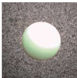
Bohrer mit spezieller Geometrie und Diamantbeschichtung – keine Delamination und keine Ausfransungen.
